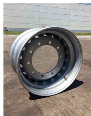
Janta din otel pentru Camion 11.75x22.5 Frana Tambur Greutate : 45 kg
