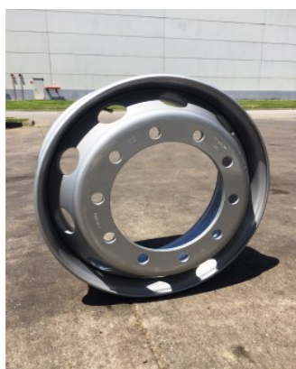
Janta din otel pentru Camion 9.00x22.5 Cap Tractor Greutate :45 kg
